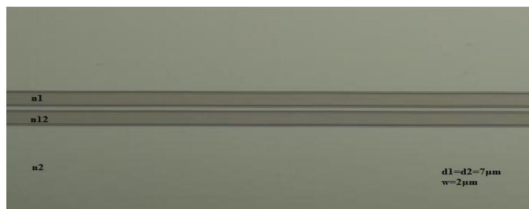
**Figure 7 :** Photo d'un coupleur directionnel<sup>2</sup>
