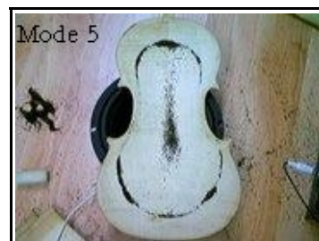
Mode de vibration d'un dos de violon observé par la méthode dite de Chladni
