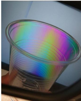
FIGURE 2.1 – Biréfringence due à une contrainte mécanique imposée par la forme du gobelet éclairé par une lumière polarisée (écran d'ordinateur) et filtré par un analyseur (verre de lunettes de Paul polarisant).
