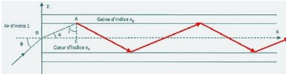
FIGURE 3.3 – Schéma d'une coupe longitudinale d'une fibre montrant les réflexions totales (Extrait de [5]).
